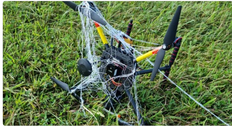
Aufnahmen einer mit einem Netz gefangenen Kleindrohne im Rahmen des Forschungsprojektes „FALKE“ der Bundeswehr-Universität Hamburg, (C) HSU / Jan Cornils.
